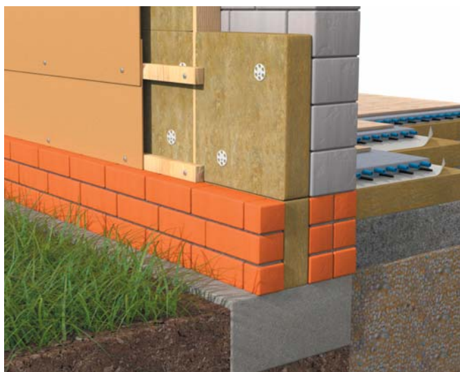
Схема утепления фасадов и пола
